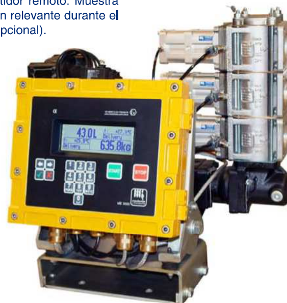
Contador con calculador electrónico ME3000 con doble indicación para controlar dos cámaras simultáneamente. Cada cámara puede tener múltiples válvulas VN para salida por varios puntos no simultáneos, sonda de temperatura, y predeterminación de la cantidad a suministrar.
